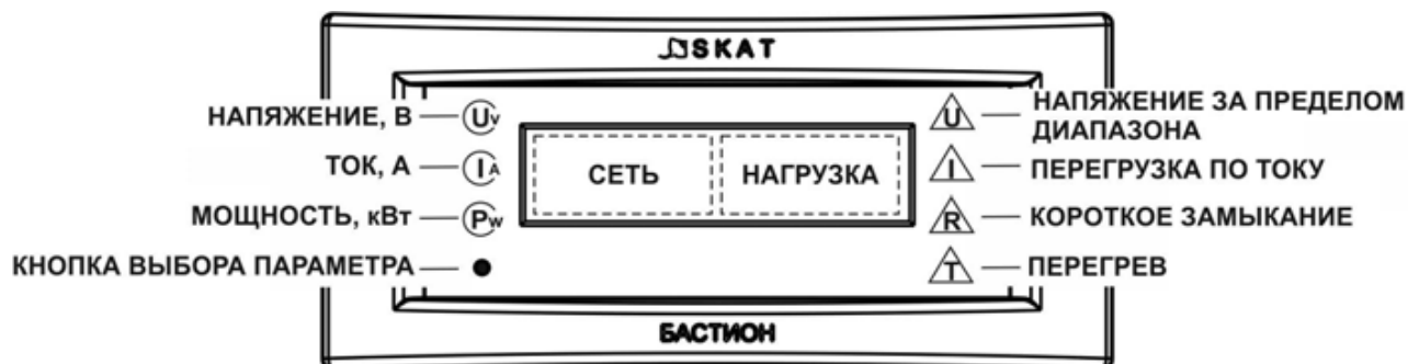
Рисунок 2 - Индикация и органы управления
