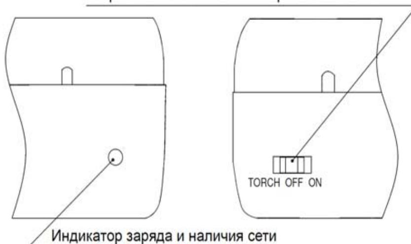
Рисунок 1. Назначение органов управления и индикации. ON - включено, OFF - выключено, TORCH - фонарик.
